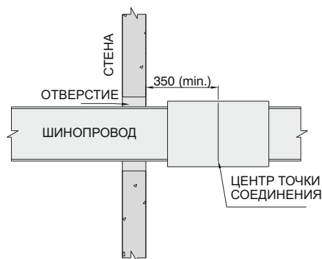
РИСУНОК 7 - ПЕРЕСЕЧЕНИЕ СТАНДАРТНОЙ СТЕНА
